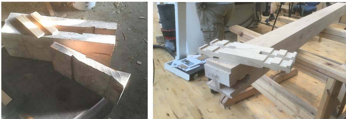
Til venstre: Japansk, såkaldt 'Hinoki' (= spækhugger) – samling, en løs tap med låsekiler, hjembragt fra Japan. Til højre: Den tilsvarende CNC-fræsede løse tap med låsekiler, der kan samle to bjælkeender, uden jernbeslag.
